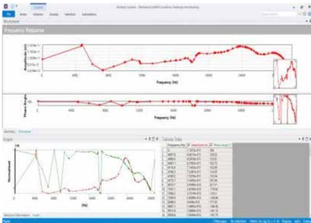
**Figura 9.** Respuesta armónica con respecto al desplazamiento de la caja de fibra de vidrio con polvo de balsa
