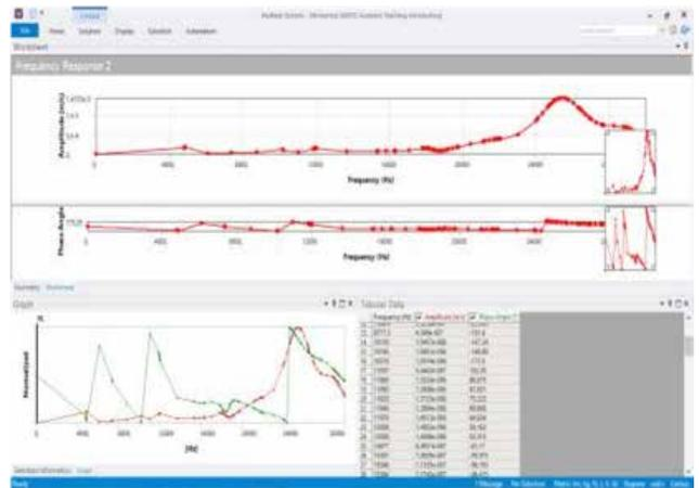
**Figura 11** Respuesta armónica con respecto a la aceleración de la caja de madera
