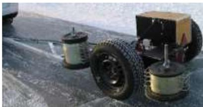
**Figura 1.1** Llanta dinamométrica
