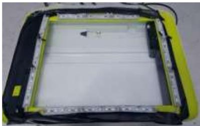
**Figura 3.5** Barras led colocadas alrededor del marco del escáner
