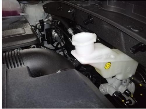
**Figura 64: Depósito de líquido de frenos**
